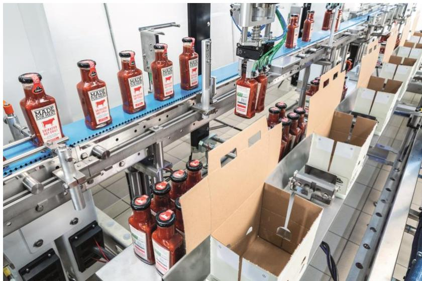
Im Gegenlaufprinzip verpackt: Je zwei Schachtelzuschnitte werden auf dem Transmodul abgestellt, während Pick-and-Place-Roboter zwei Flaschen vom Produktband aufnehmen und in gewünschter Anzahl auf dem Transmodul platzieren. (Foto: © Gerhard Schubert GmbH)
