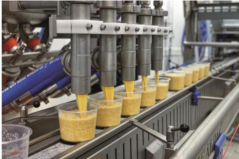
Bei der Linie sorgt ein Walking-Beam-System für eine exakte Positionierung der Trays unter den Füllköpfen. (Foto: © Sealpac)
