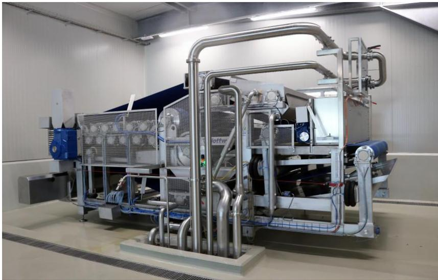
Die Flottweg Bandpressen sind nach der Waschung, Vorsortierung und Zerkleinerung der Äpfel die zentrale Einheit für die Saftgewinnung. (Foto: © Flottweg)
