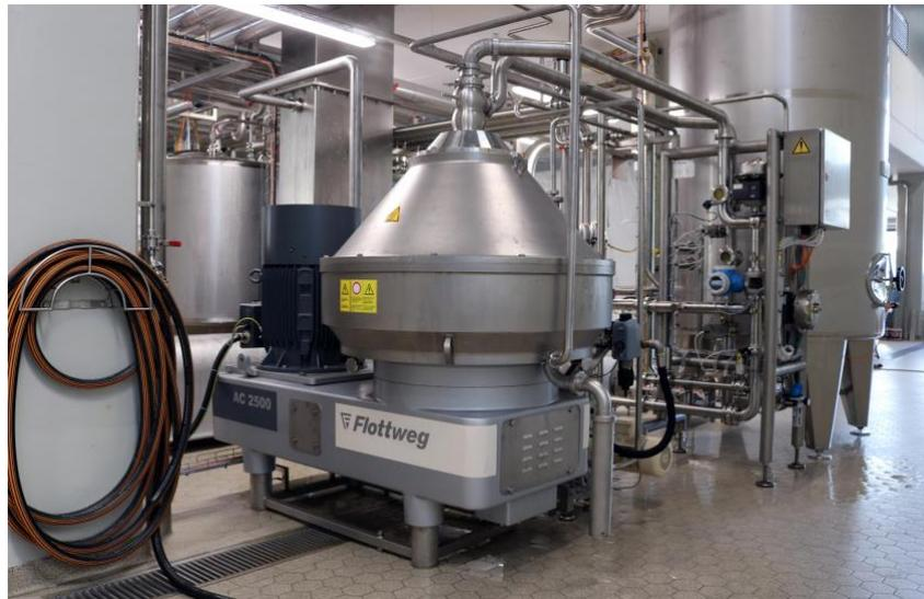
Flottweg Separator zur Klärung von Fruchtsäften. Um eine Anhaftung von Ablagerungen zu vermeiden, sind die Edelstahlkomponenten im Inneren der Anlage mit einer besonders glatten Oberflächengüte gefertigt. (Foto: © Flottweg)
